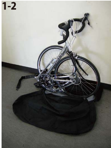
前輪、ペダルを外し、車体を折り畳みバッグ中央に置きます。 (注意：バッグを閉めたときに、図1-3と同じ方向になるように置いてください) その他の部品は互いに傷つかないように、袋などに入れるかフレームに固定してください。
